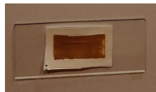
სურათი 5. FTU-0,03 და FTU-50 სიმღვრივის ზუნებრივი წყლების მიკროფილტრაციის შედეგად მემბრანის ზედაპირზე წარმოქმნილი დანალექი
