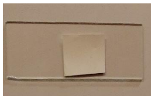
სურათი 5. FTU-0,03 და FTU-50 სიმღვრივის ზუნებრივი წყლების მიკროფილტრაციის შედეგად მემბრანის ზედაპირზე წარმოქმნილი დანალექი
