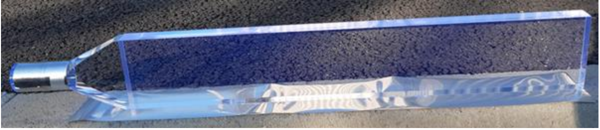
სურ. 7 ტრიგერში გამოყენებული სქელი სცინტილატორები
