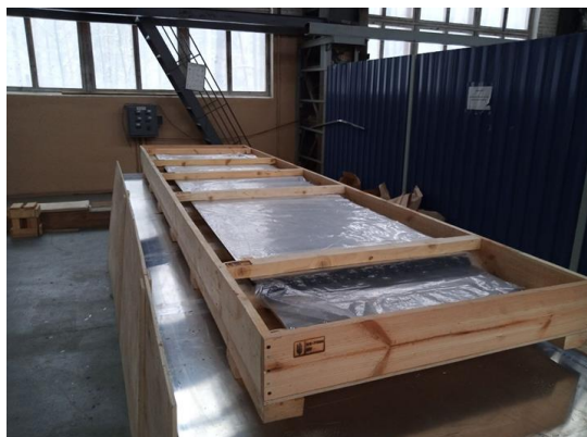
სურ. 24 CRV მოდული, გამზადებული გადასაგზავნად: მისი ზომებია 3.5 მეტრი ზიგრძის და 830 მმ სიგანის, 57 მმ სიმაღლის და მიახლოებით 290 კგ წონის
