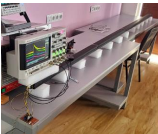
სურ. 26 სტენდი 4 CRV სტრიპისგან, ჩართული თანხვედრაში კოსმოსურ ტელესკოპთან და მათი სიგნალების ვიზუალიზაცია Kesight InfiniiVision MSOX3104T ოსცილოგრაფის მეშვეობით
