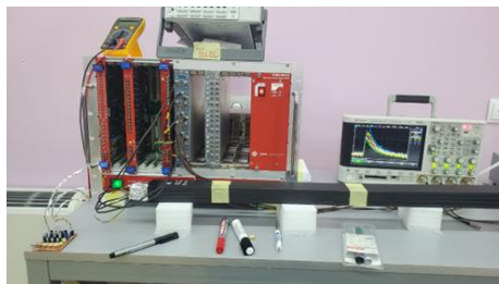
სურ. 26 სტენდი 4 CRV სტრიპისგან, ჩართული თანხვედრაში კოსმოსურ ტელესკოპთან და მათი სიგნალების ვიზუალიზაცია Kesight InfiniiVision MSOX3104T ოსცილოგრაფის მეშვეობით
